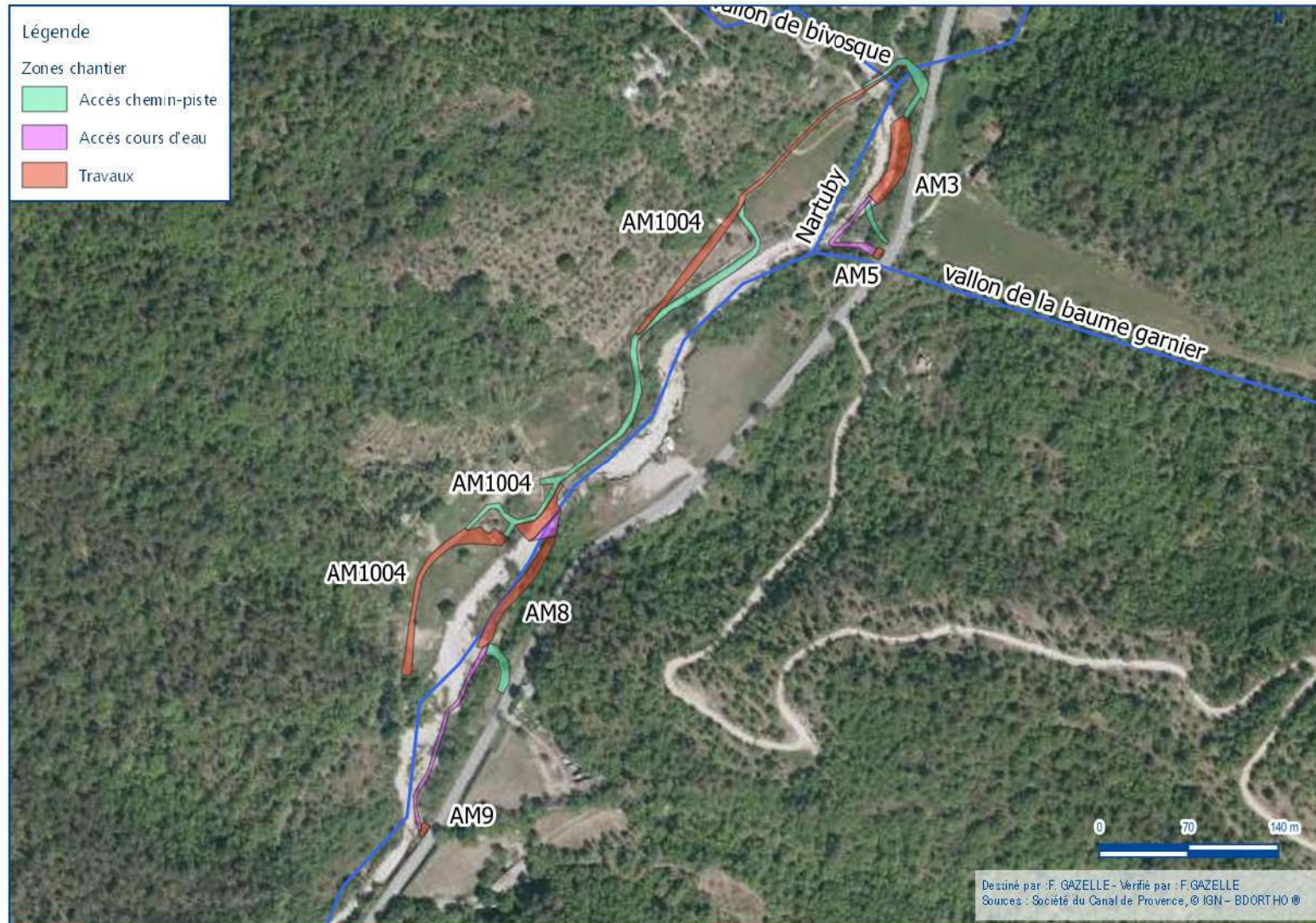
Figure 41 : Plan de chantier – Zones Nord
