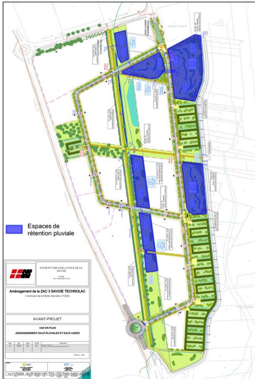
Zone d'implantation des ouvrages de rétention des eaux pluviales dans l'emprise du projet
