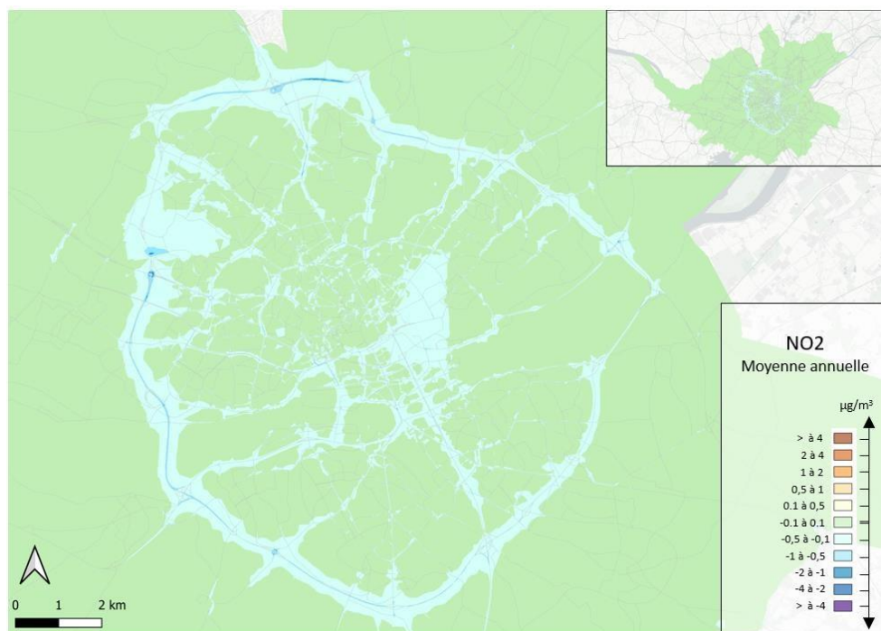
Figure 46 : Carte de différence du NO 2 du scénario « ZFE2 » par rapport au « Tendanciel 2030 » - Source : Air Pays de la Loire
