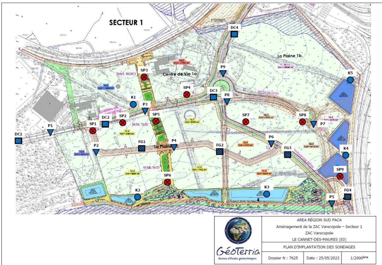
*Localisation des tests de perméabilité « K » réalisés sur le secteur 1 de la ZAC VARECOPOLE*
