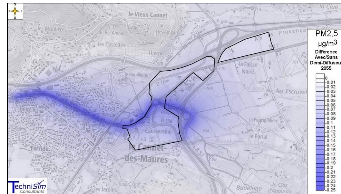
Figure 70 : Différence de concentration en PM2,5 entre les situations Projetée 2055 Avec/Sans Demi-Diffuseur (Situation 7 – Situation 5)
