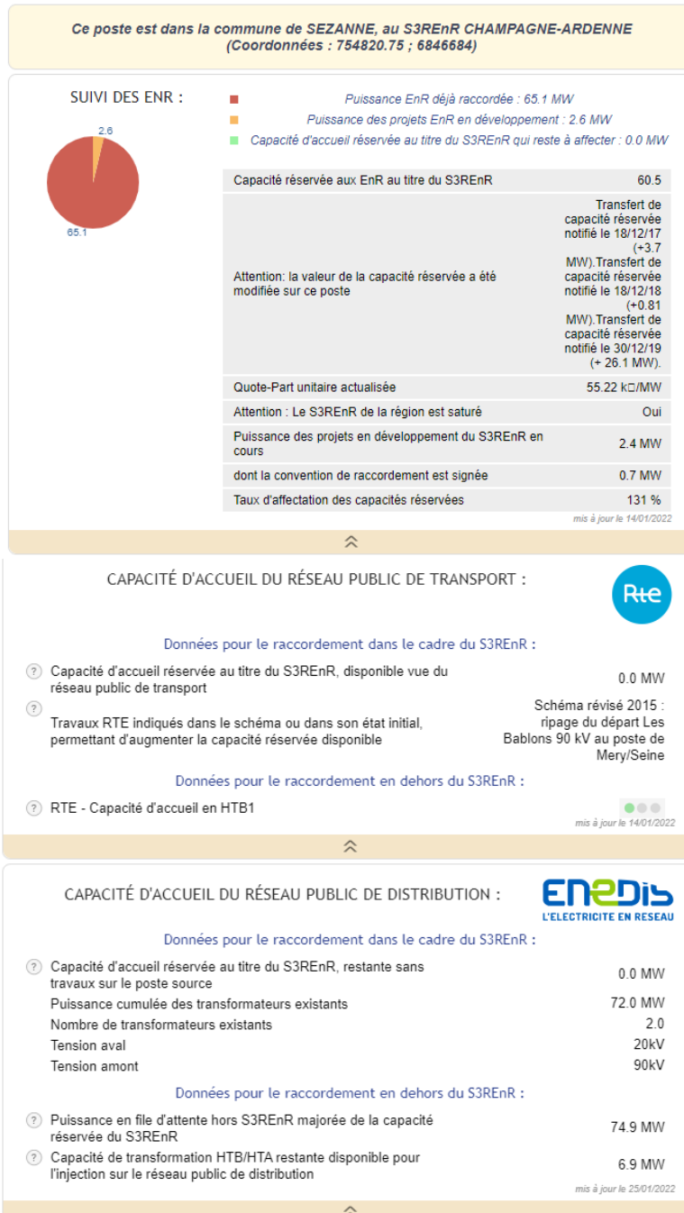
Figure 16 : Capacité du poste de Sézanne sur la commune de Sézanne (Source : capreuseau.fr, 2022)
