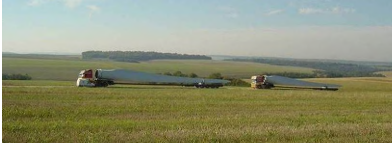
Figure 26 : Exemple de transport de pale par camion
