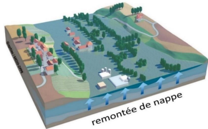
Figure 10 : Le phénomène d'inondation (Source : georisques.gouv.fr)
