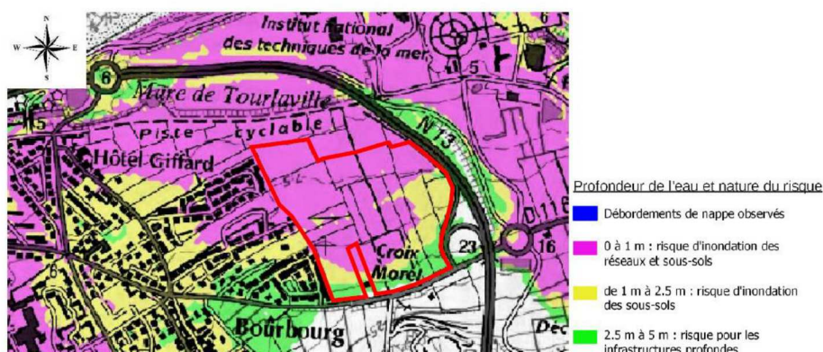
Extrait de la cartographie de la profondeur de la nappe phréatique en période de très hautes eaux
