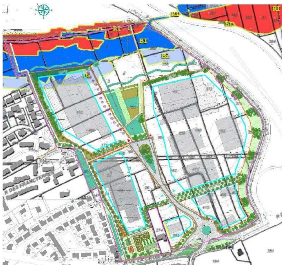
Report des zones de submersion marine sur le plan masse (source : mosaic)
