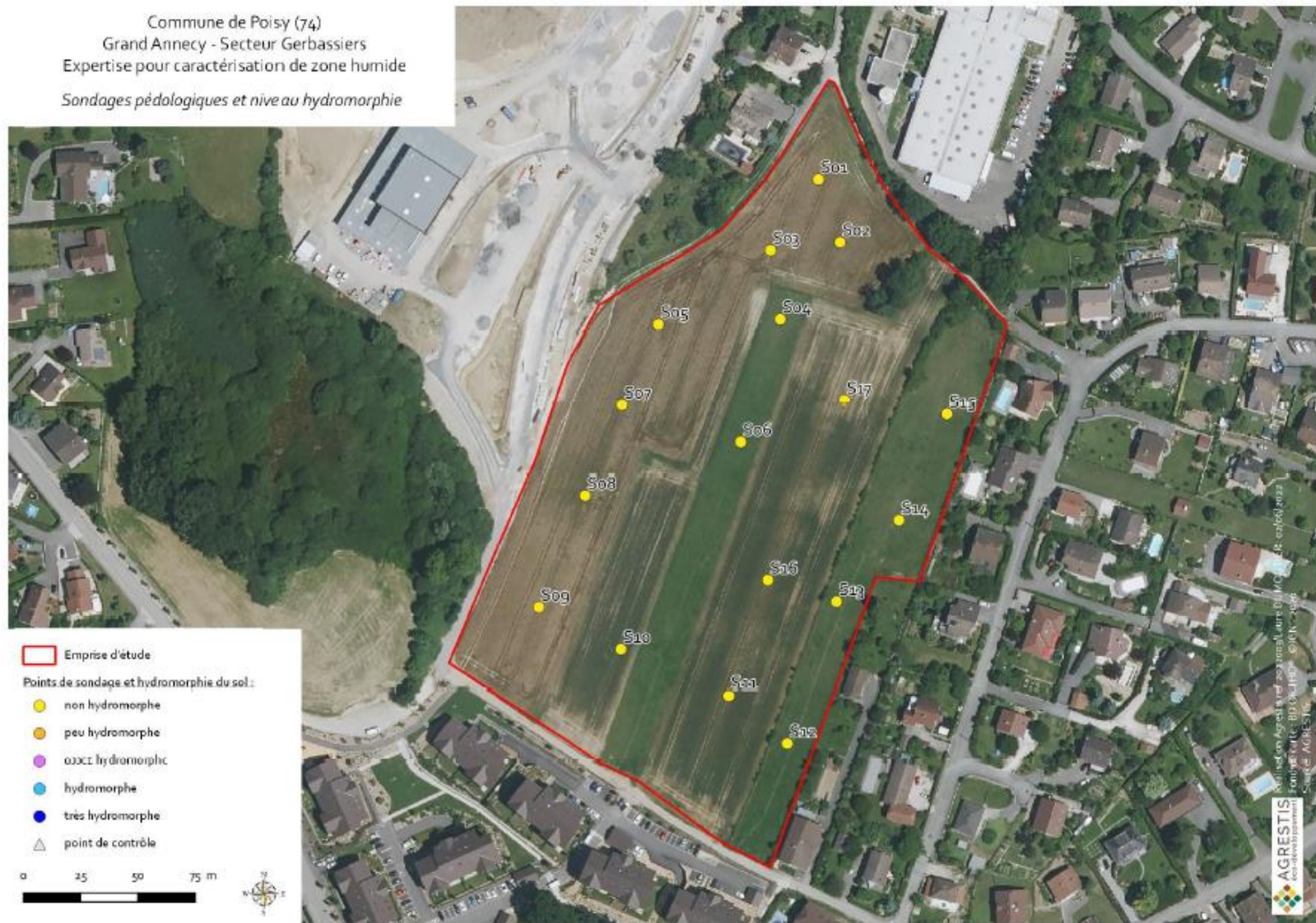
Figure 48 : Sondages pédologiques et niveau d'hydromorphie
