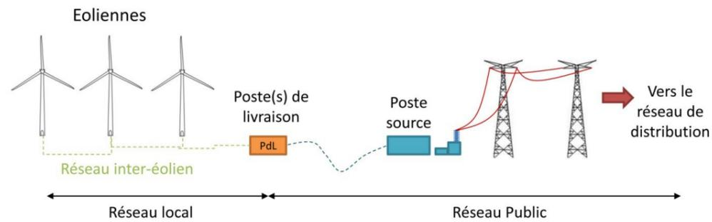
Illustration 7: Raccordement électrique des installations
