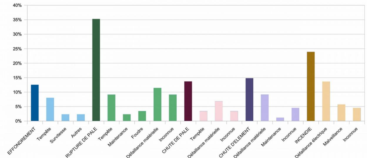
Par ordre d'importance, les accidents les plus recensés sont les ruptures de pale, les incendies (nombreux cas criminels), les effondrements, les chutes de pale et les chutes d'éléments de pale. La principale cause de ces accidents est liée à la conception des machines, régulièrement mise en cause en cas de tempêtes.
