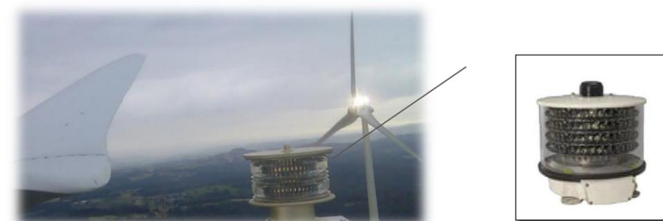
Figure 32 : Balisage d'une éolienne
