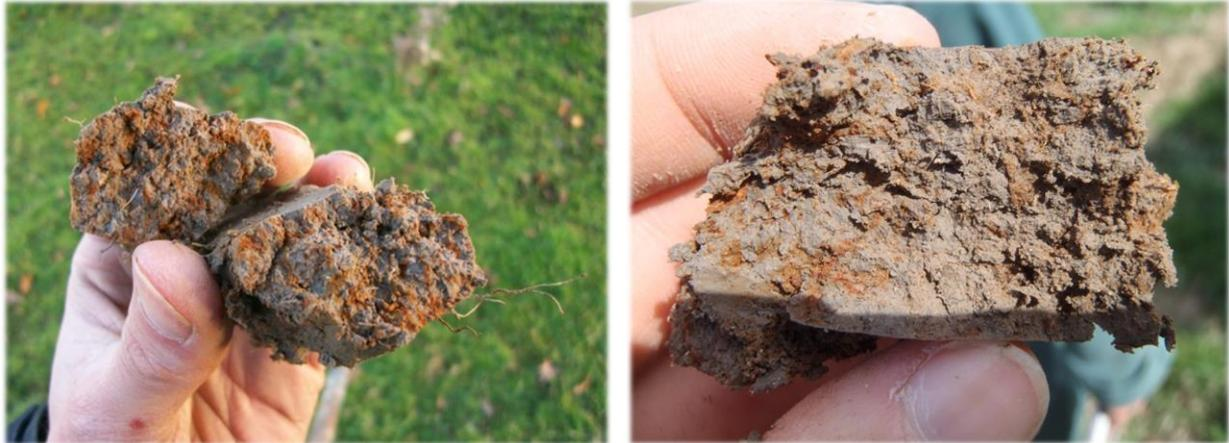
Figure 156 : Illustrations d'un sol caractéristique de zone humide (rédoxisol)
