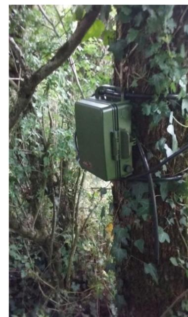
A cette écoute active a été associée une écoute « passive », à travers la pose de deux enregistreurs continus SM4BAT. Les détecteurs passifs permettent d'accumuler une grande quantité de données puisque l'enregistrement est réalisé en continu. Ce type d'écoute permet d'apprécier plus finement les variations d'activité au cours de la nuit sur un point donné.
