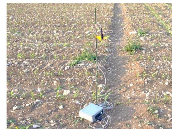
Figure 12 : Exemple d'installation de détecteur dans les cultures, SM2BAT+ et micro SMM-U1 © NCA Environnement
