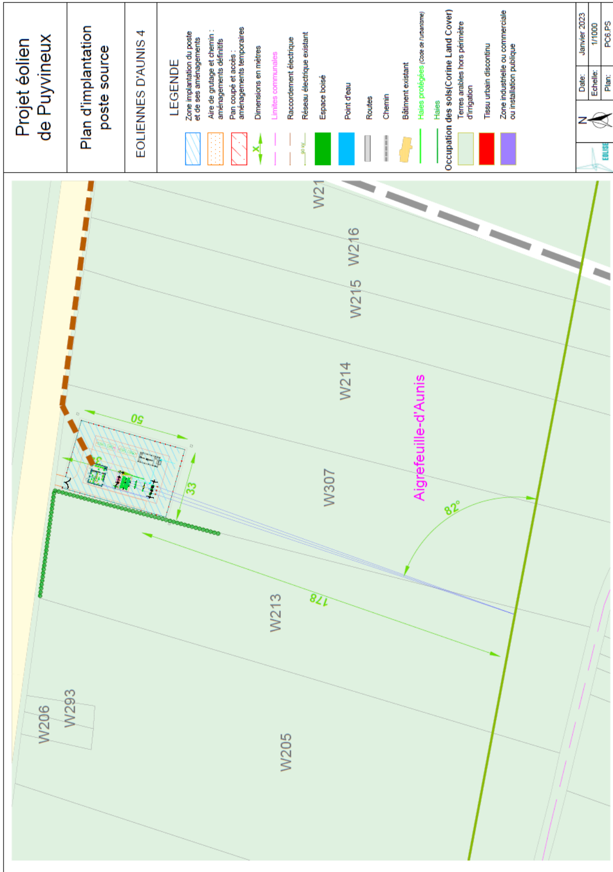
Figure 8 : Plan d'implantation du poste source (source : EOLISE)
