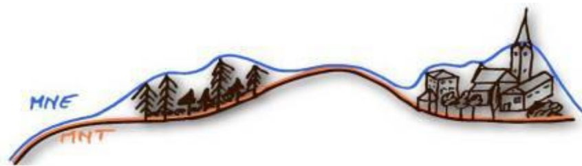
Figure 60 : Modèle Numérique de Terrain et Modèle Numérique d'Élévation (Source : BE Jacquiel et Chatillon)
