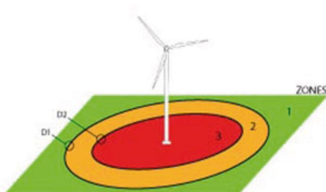
Figure 19 : Distances de sécurité entre une éolienne et un ouvrage de GRT gaz
