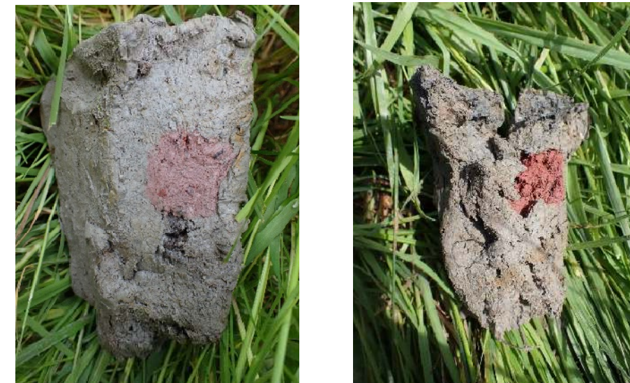
Photo 1 : Exemple du précipité rouge de la réaction du test à la phénanthroline
