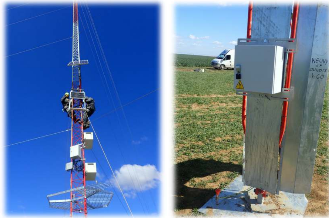
Photo 2 : Installation du matériel acoustique autonome sur le mât de mesure
