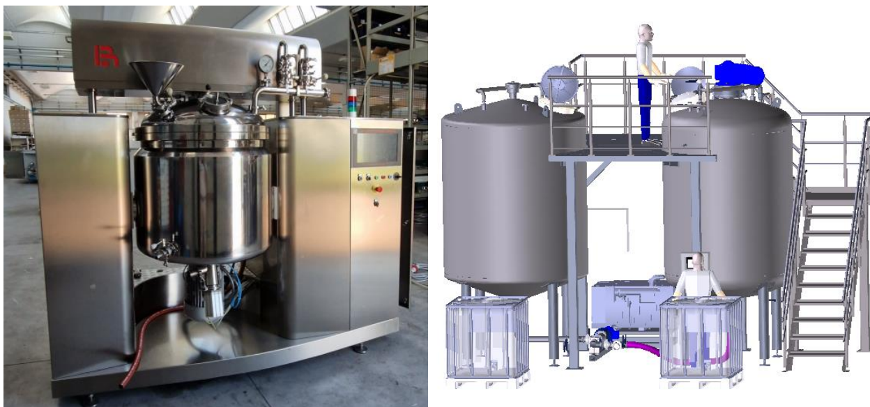
Figure 7 : Enceintes fermées des mélangeurs
