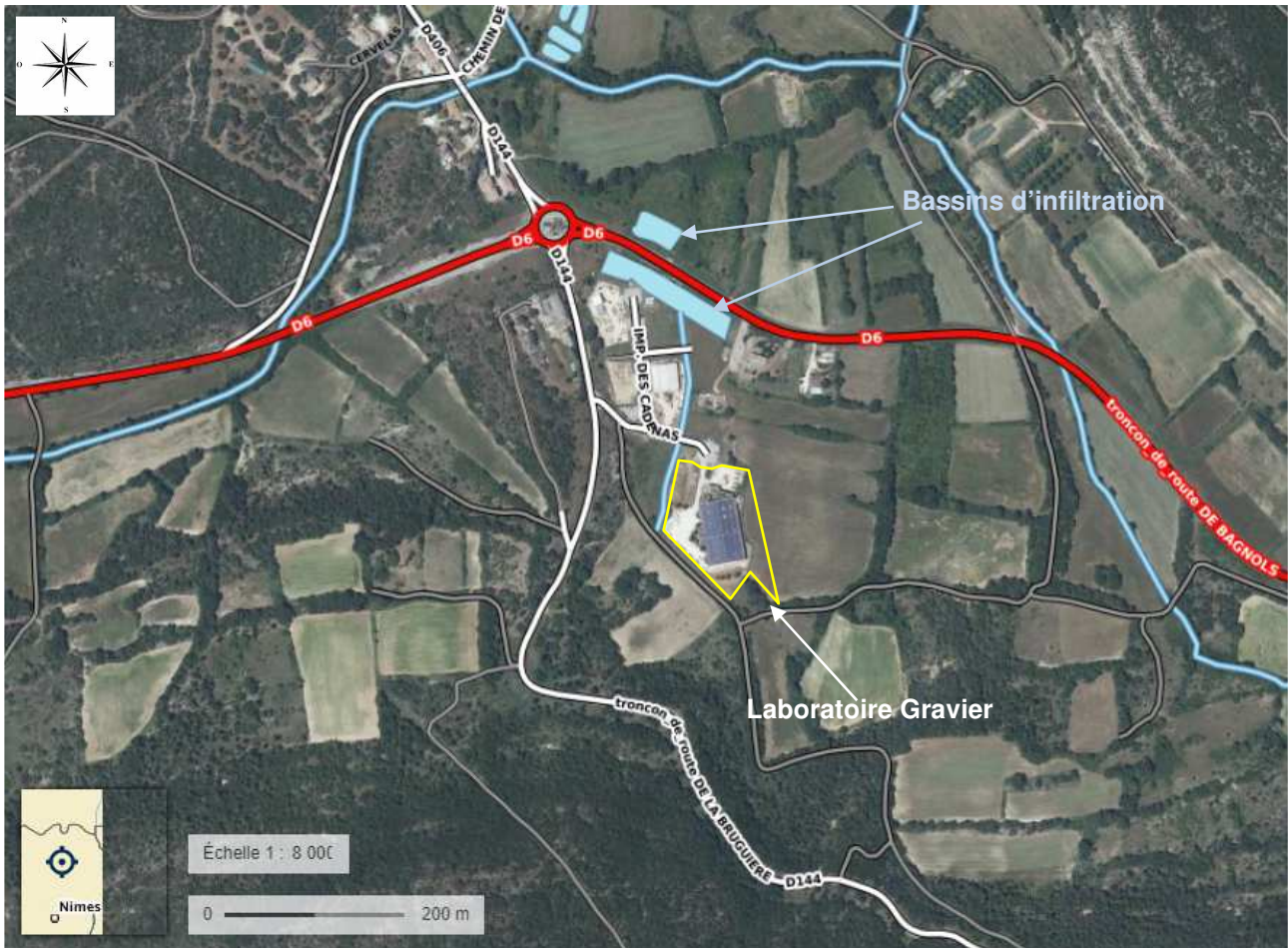
Figure 14 : Gestion des eaux pluviales à l'échelle de la ZAE du Grand Lussan
