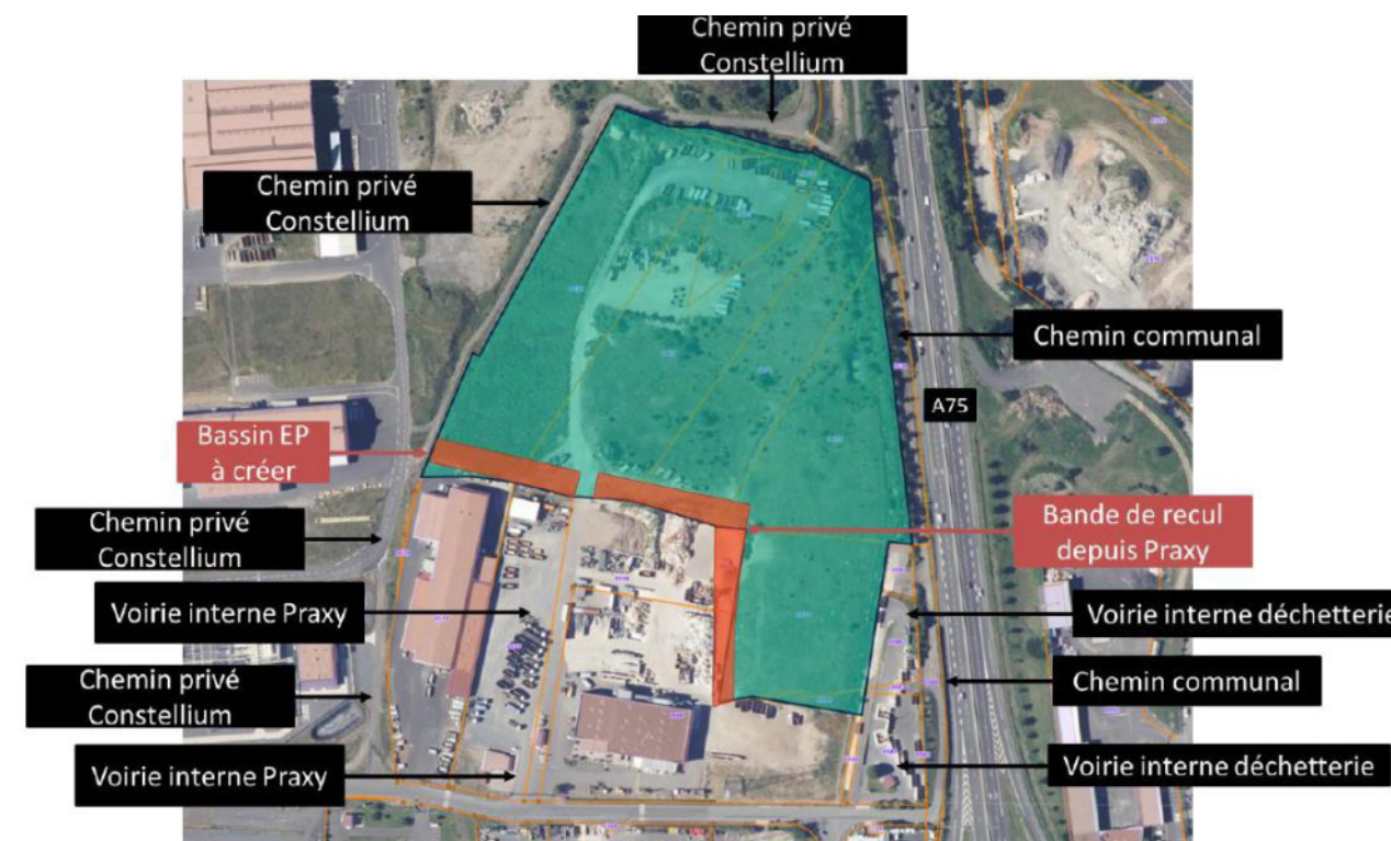
Eléments assurant une accessibilité au site par les services de secours
