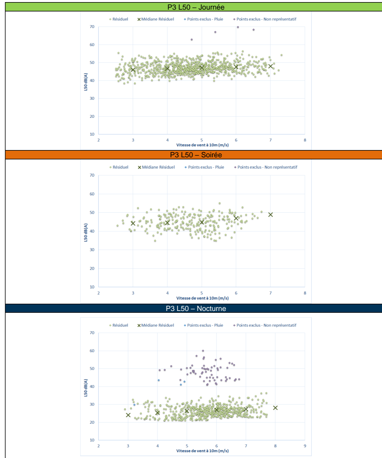
Figure 49. Bruit en fonction de la vitesse de vent standardisée au point P3 – Période estivale
