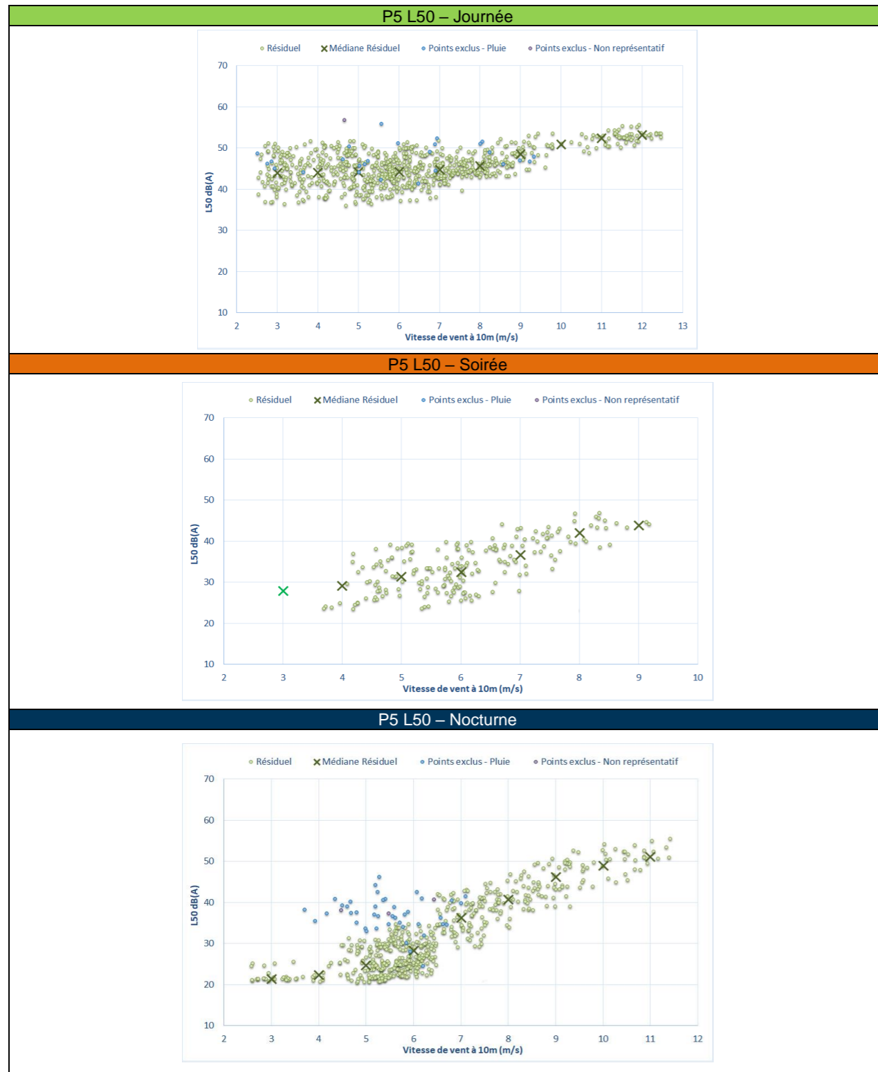
Figure 52. Bruit en fonction de la vitesse de vent standardisée au point P5 - Période hivernale
