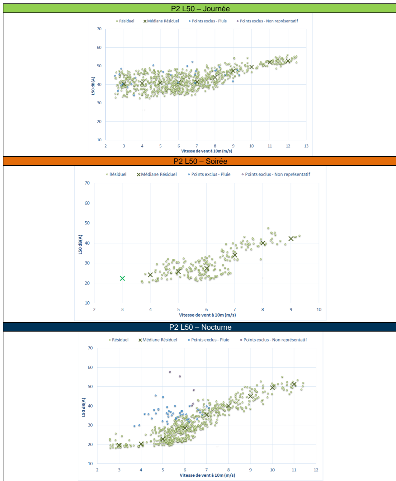
Figure 46. Bruit en fonction de la vitesse de vent standardisée au point P2 – Période hivernale
