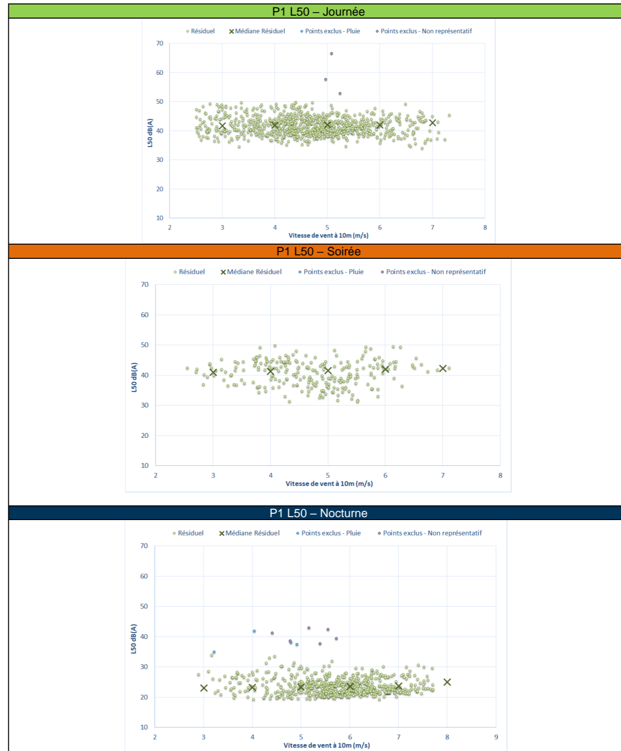
Figure 45. Bruit en fonction de la vitesse de vent standardisée au point P1 – Période estivale
