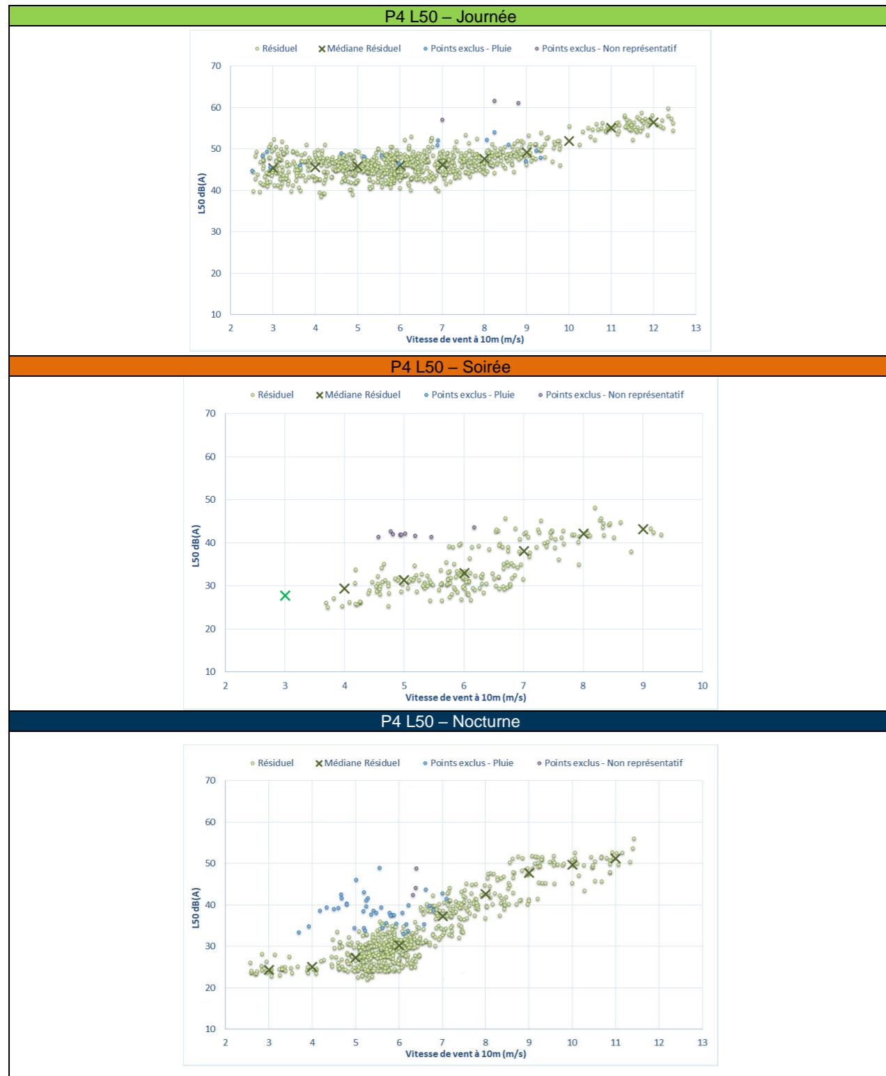
Figure 50. Bruit en fonction de la vitesse de vent standardisée au point P4 – Période hivernale
