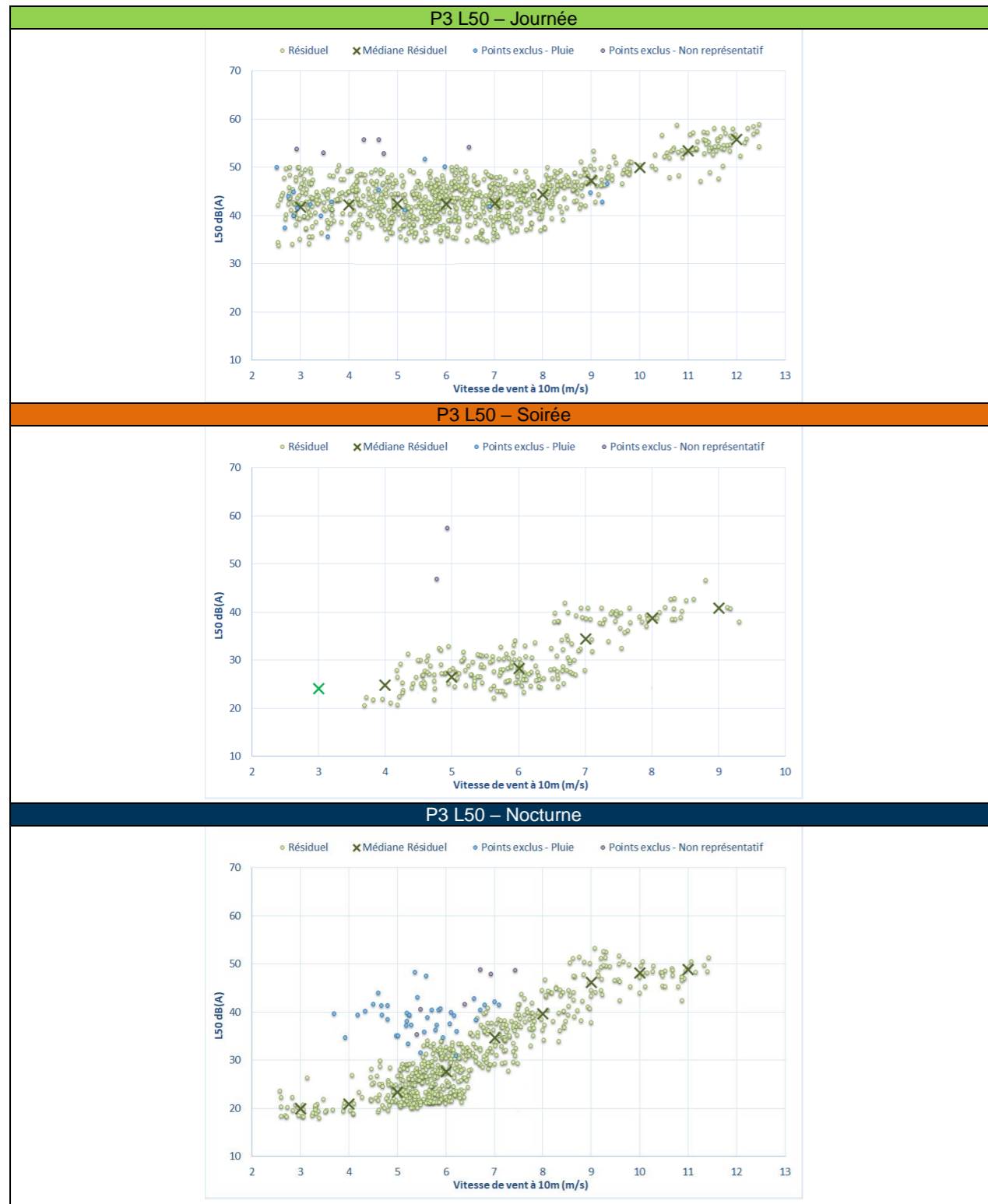
Figure 48. Bruit en fonction de la vitesse de vent standardisée au point P3 – Période hivernale
