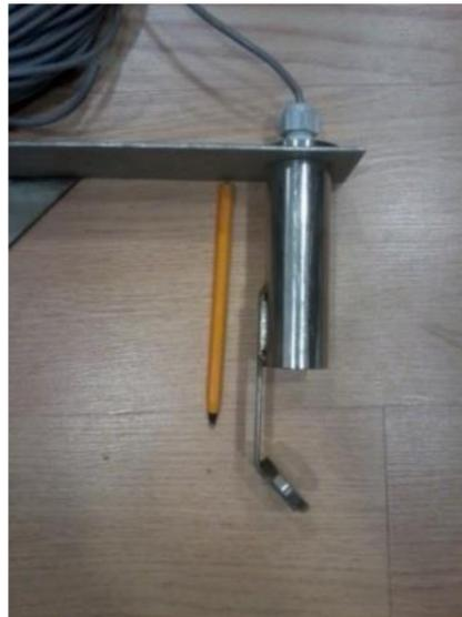
Figure 348. Illustrations d'un SM3BAT et de la protection du microphone © Biotope
