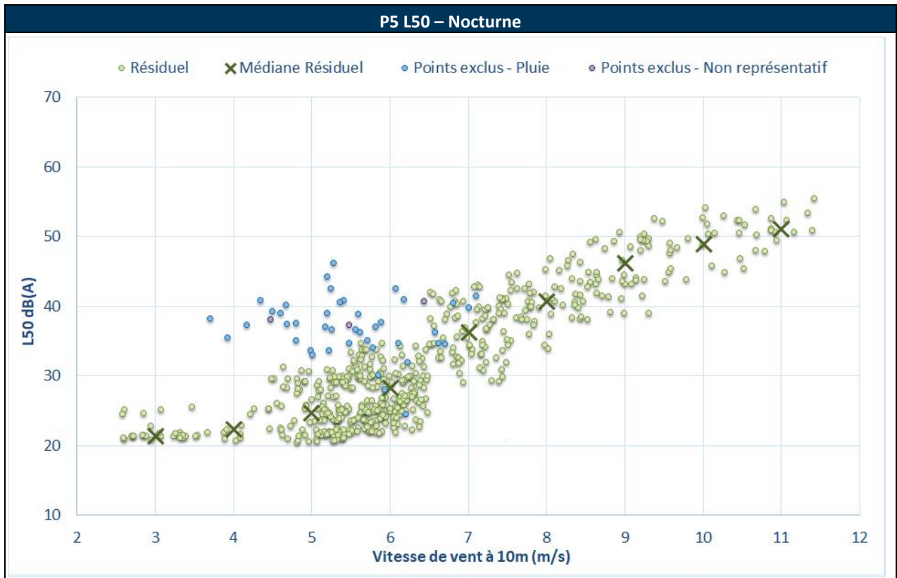
Figure 15 : Bruit en fonction de la vitesse de vent standardisée au point P5 - Période hivernale
