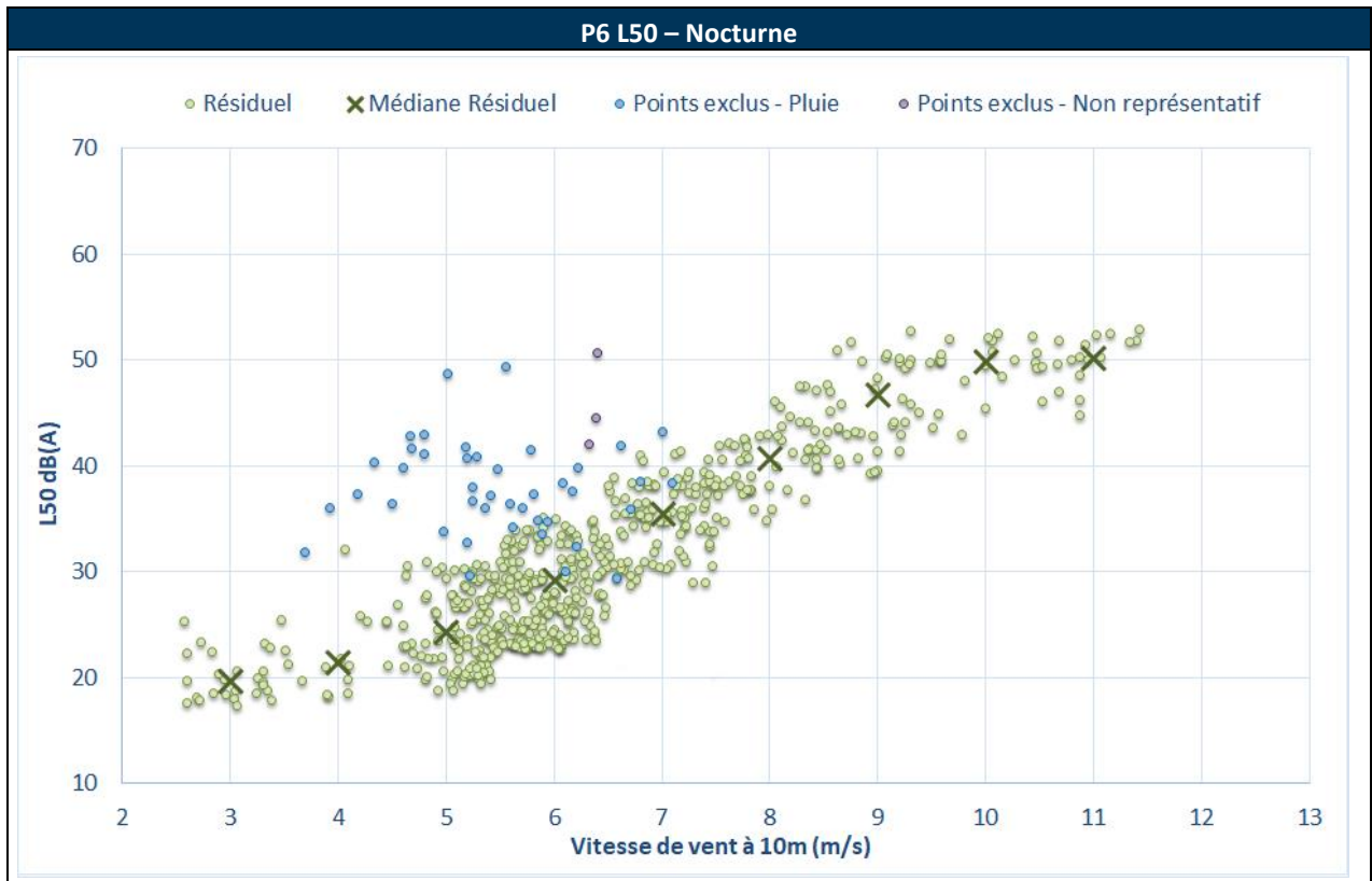
Figure 17 : Bruit en fonction de la vitesse de vent standardisée au point P6 – Période hivernale
