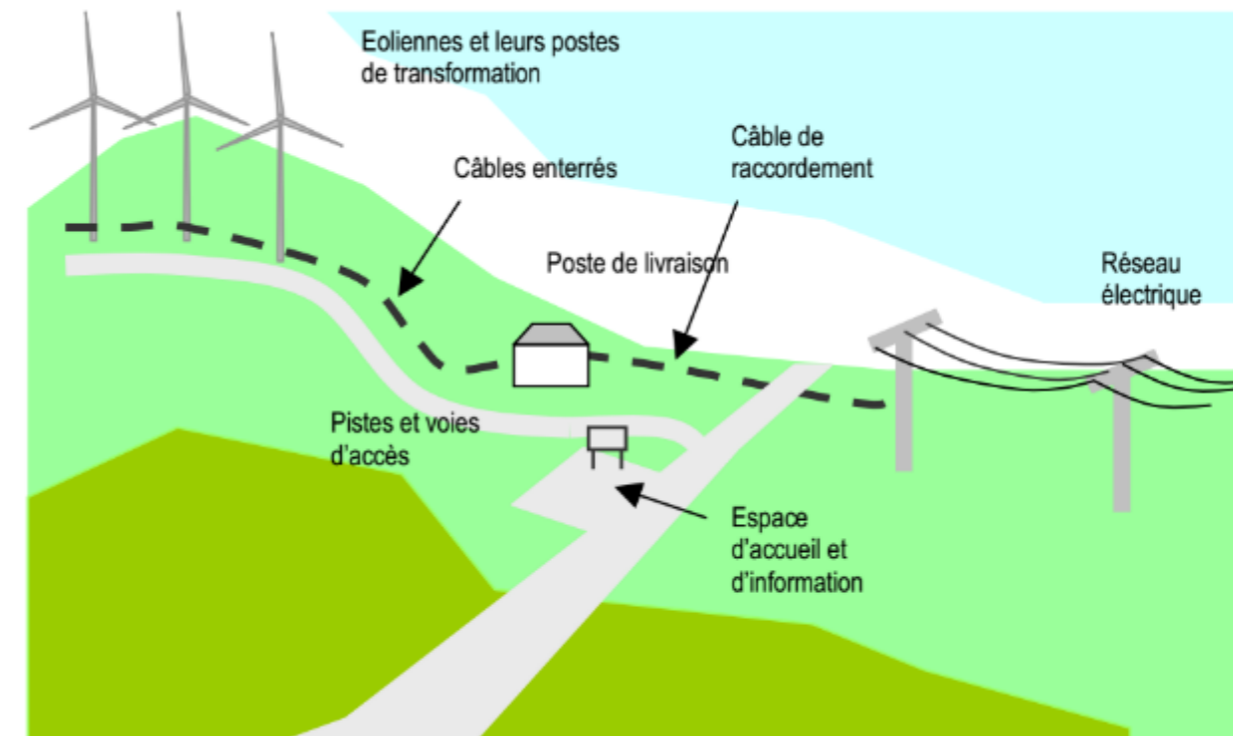
Figure 4. Schéma descriptif d'un parc éolien terrestre (rapports d'échelle non représentatifs) (Source : Ministère de l'environnement et du développement durable, Guide de l'étude d'impact sur l'environnement des parcs éoliens – Actualisation 2010)
