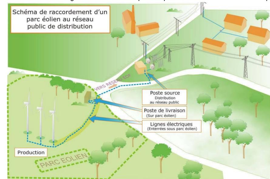
Figure 7 : Les composants d'un parc éolien (Source : ADEME)
