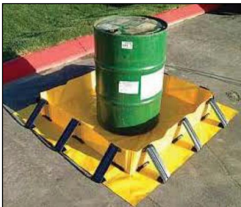
Figure I02 : Stockage de produit dangereux au sein d'un bac étanche (Source : Préfecture du Puy de Dôme)
