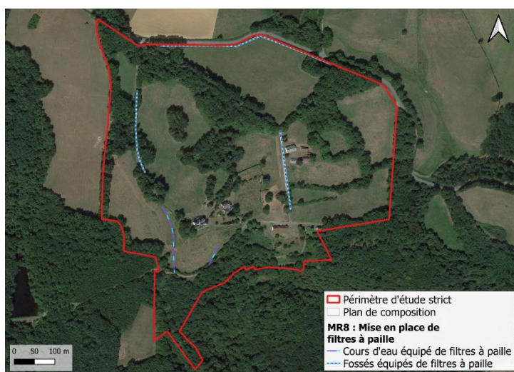
Figure 105 : Localisation des fossés et cours d'eau équipés de filtres à paille (Source : ENVOLIS)
