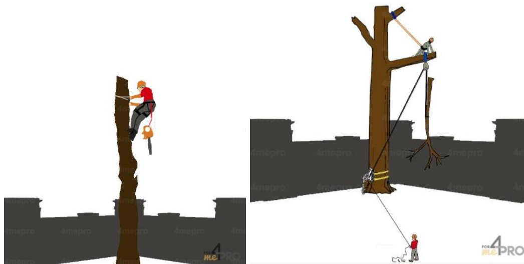
Figure 100 : Système de poulie pour le démontage du fut (Source : ECCEL Environnement, juin 2023)
