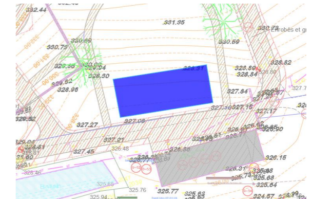
Figure 27 : Bassin enterré en casiers (SAUL) pour la gestion des eaux pluviales du BV2.
