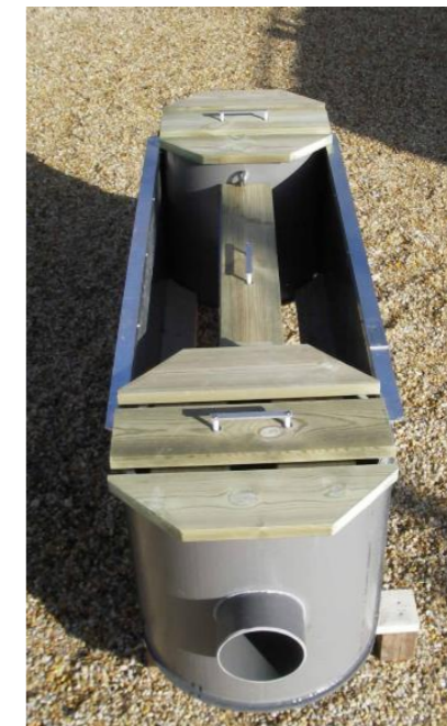
Figure 13: Exemple d'ouvrage de comptage - canal Venturi
