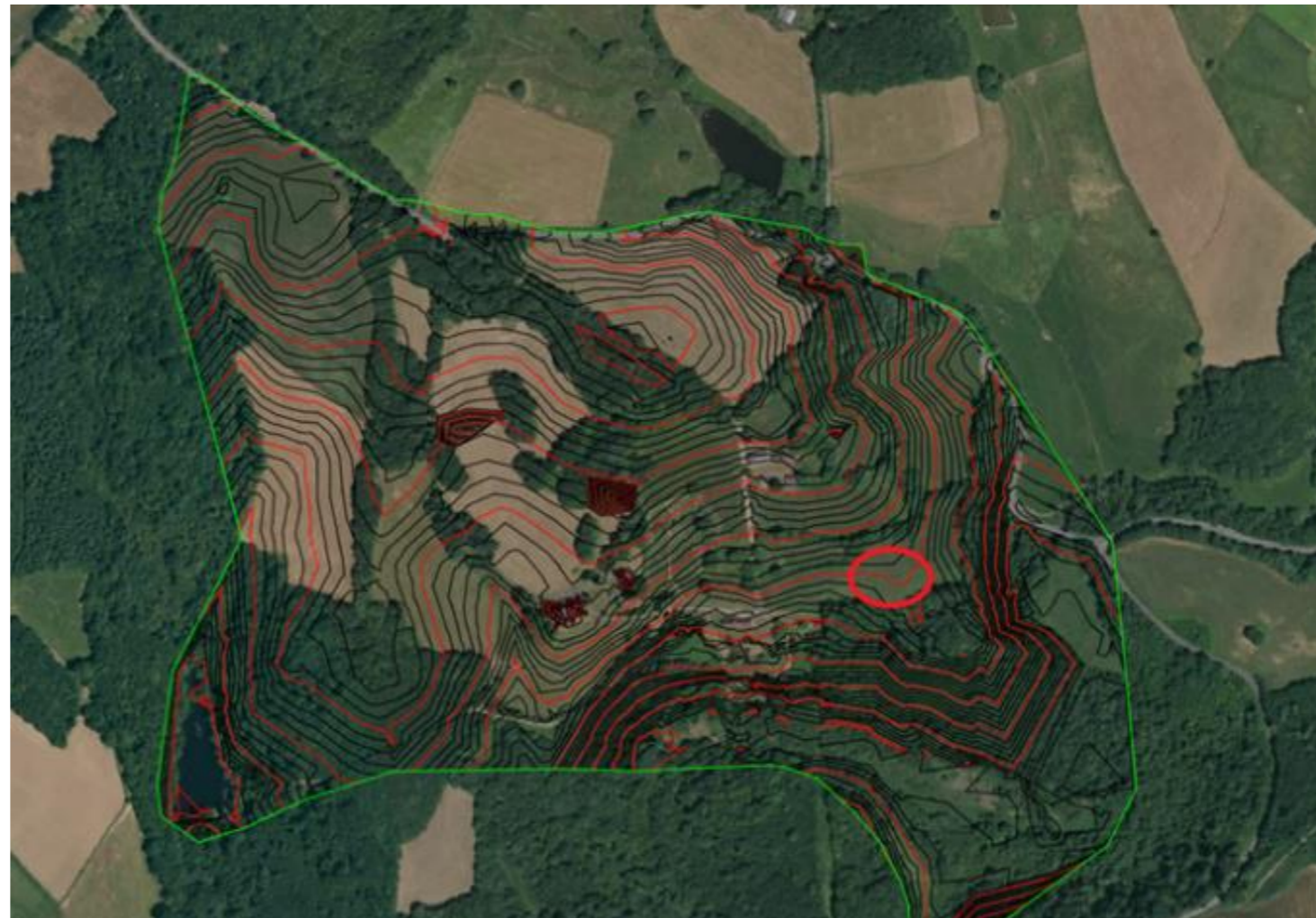
Figure 3: Détermination de la zone la plus propice à l'installation de la STEP, au vu de la topographie du site (cercle rouge).
