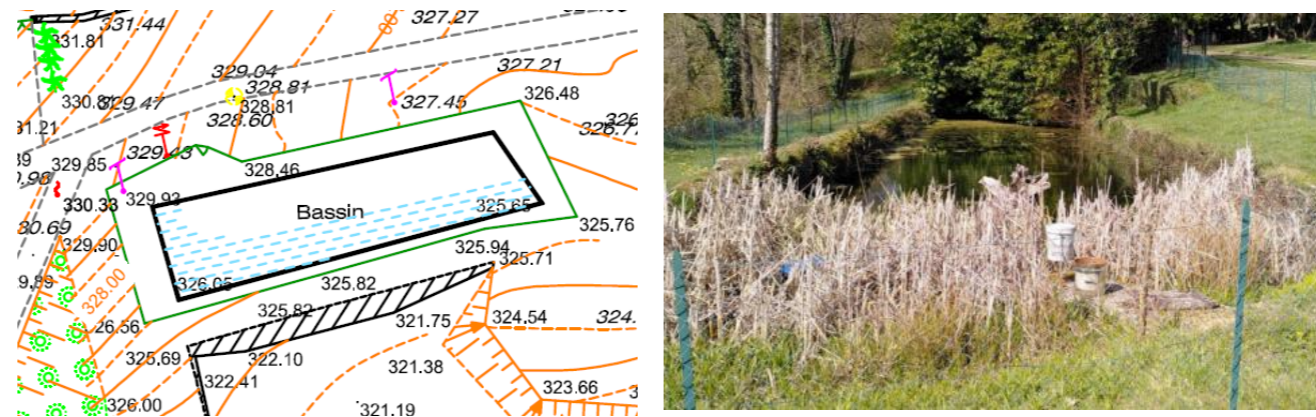
Figure 9: Bassin de rétention des eaux pluviales existant. Capacité estimée : 301 m3
