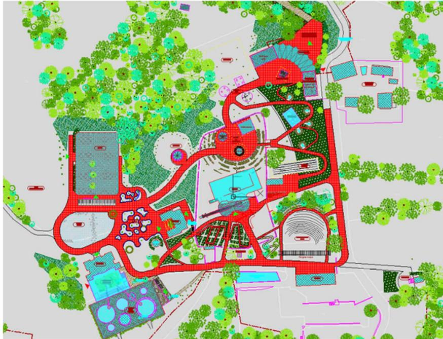
Figure 2 : Bilan des surfaces imperméabilisées du parc : partie projetée (en bleu, les surfaces liées aux bâtiments, en rose celles liées aux voiries et cheminements)
