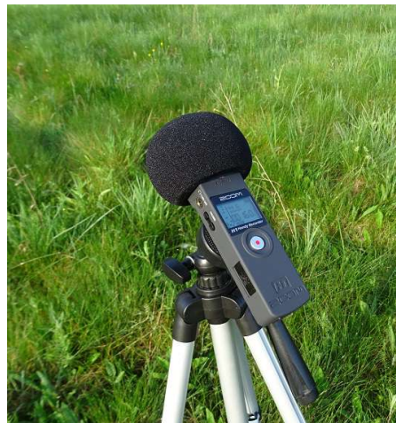
Illustration 15 : Enregistreur numérique portable, Zoom H1, avec bonnette et trépied (Source : Géonat)
