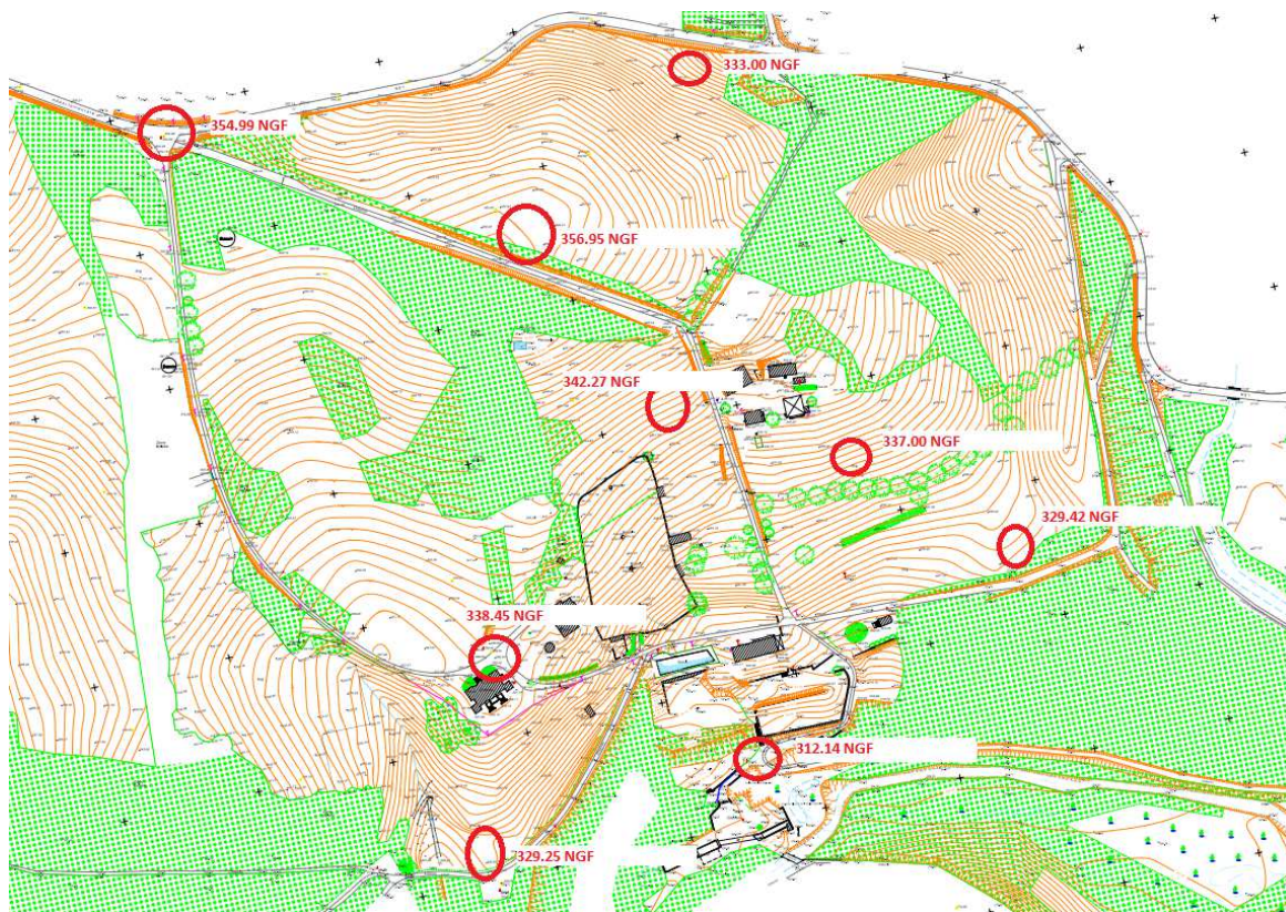
Figure 7: La différence d'altimétrie entre le point haut et le point bas du site est de l'ordre de 45m (point haut : 356.95 NGF / point bas : 312.14 NGF)
