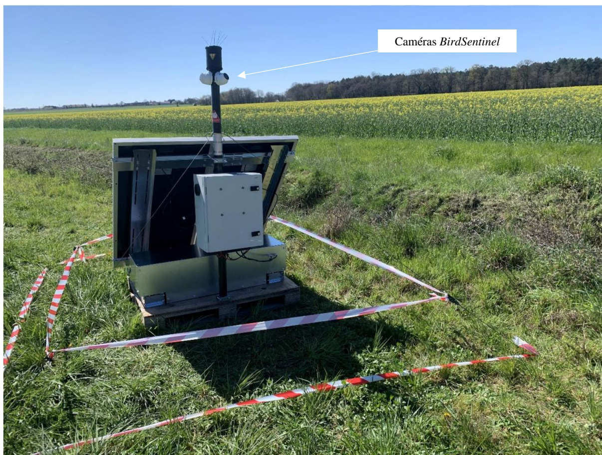
Figure 2 : Caméras BirdSentinel sur un mât autonome sur Charnizay 2
