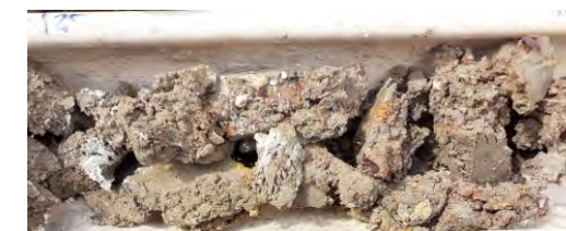
Photo 68. Sondage - Echantillon de 25 à 50 cm de profondeur - sol hydromorphe (rédoxique) avec des traits de 25 à 50 cm
