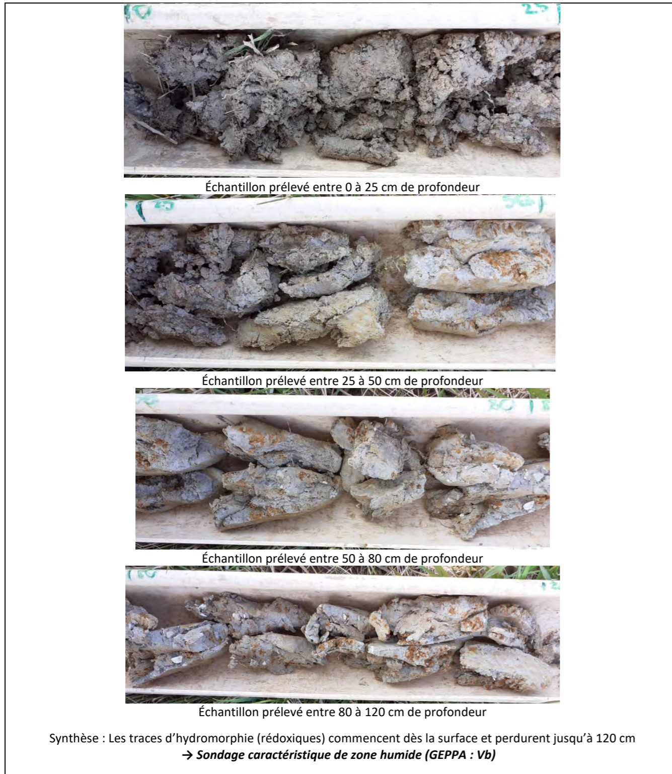
Figure 59. Sondage n°07 réalisé au sein d'une prairie de fauche améliorée
