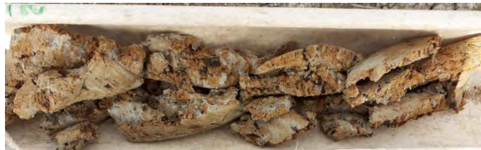
Échantillon prélevé entre 80 à 110 cm de profondeur - sol argileux
