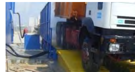
Photo 20. Plateforme de nettoyage et vidange mobile
