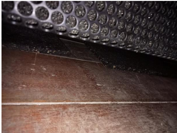
Photo 28: mousse alvéolée installée sous les caissons de basse
