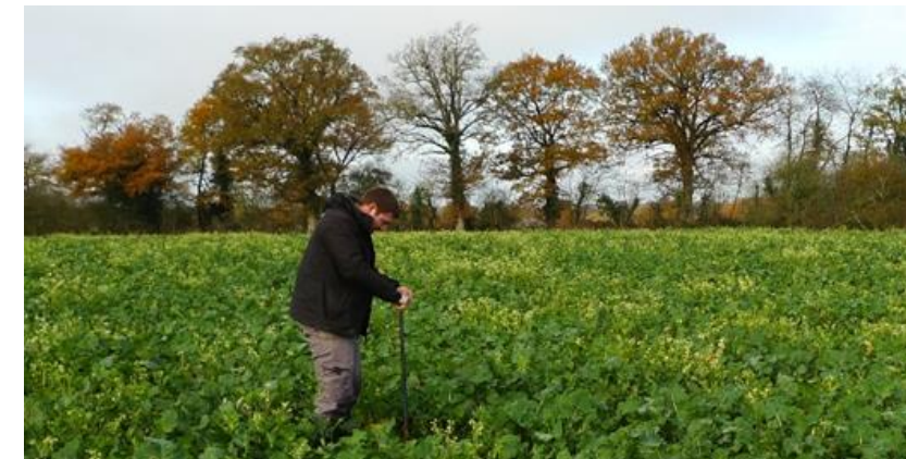
Figure 13 : Prélèvement à l'aide d'une tarière pédologique © Calidris
