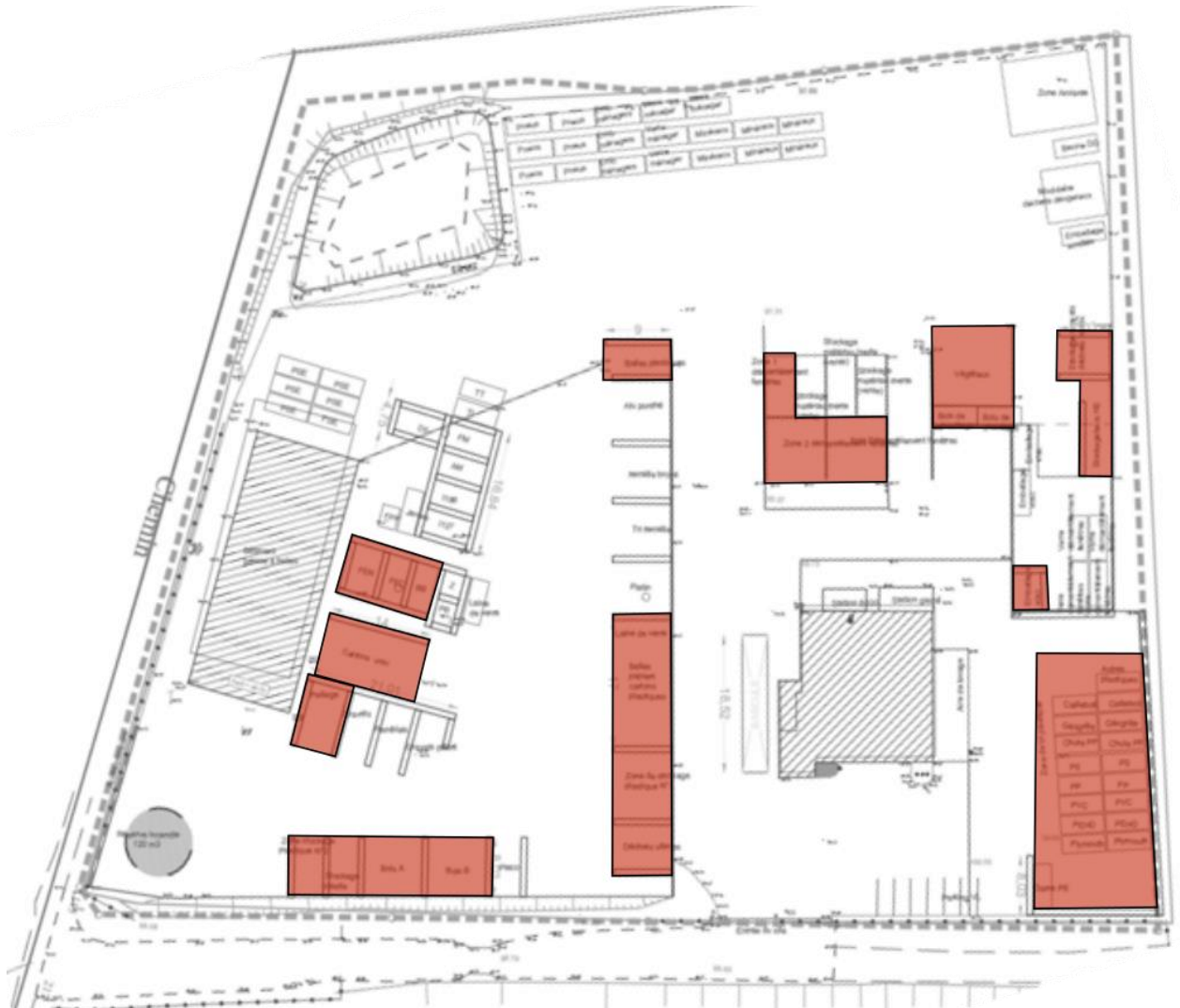
Figure 11 : Localisation des risques significatifs (incendie)
