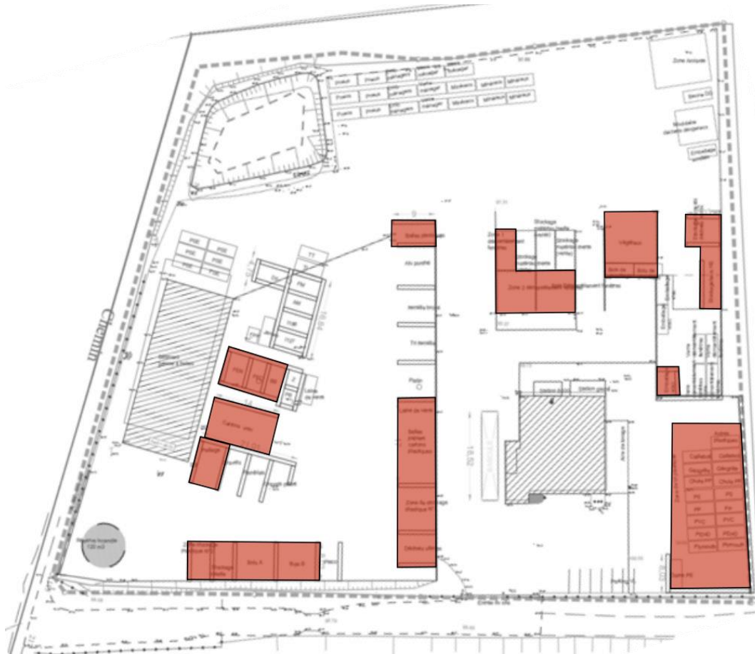
Figure 2 : Localisation des risques significatifs (incendie)
