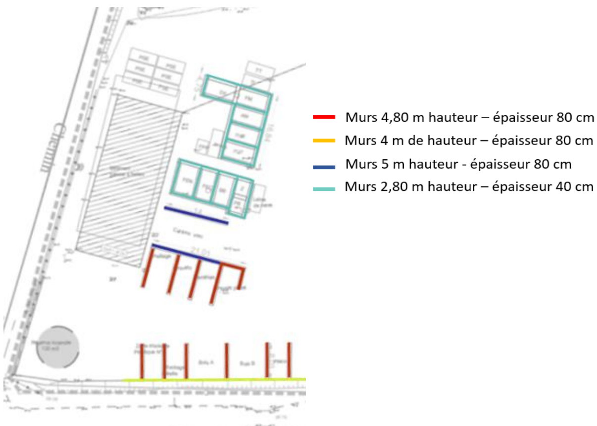
Figure 13. Localisation des murs coupe-feu et caractéristiques (fiche n°1 – scénario 1.1 et 5.1)
