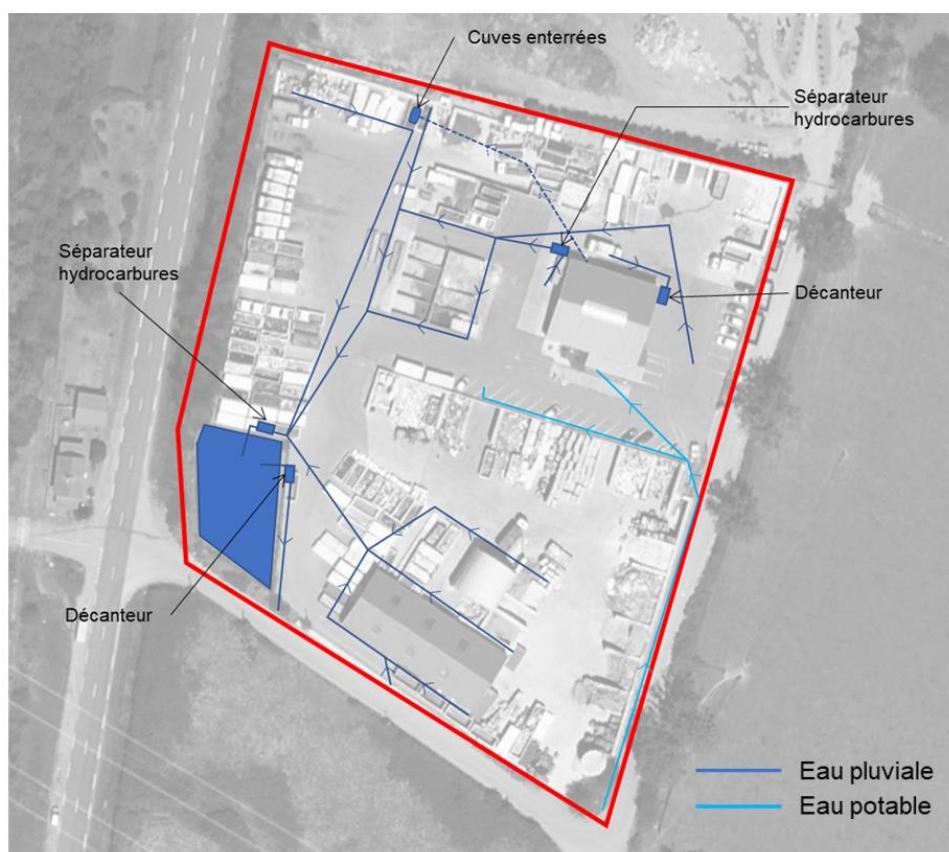
Figure 2 : Présentation schématique de la gestion des eaux du site
