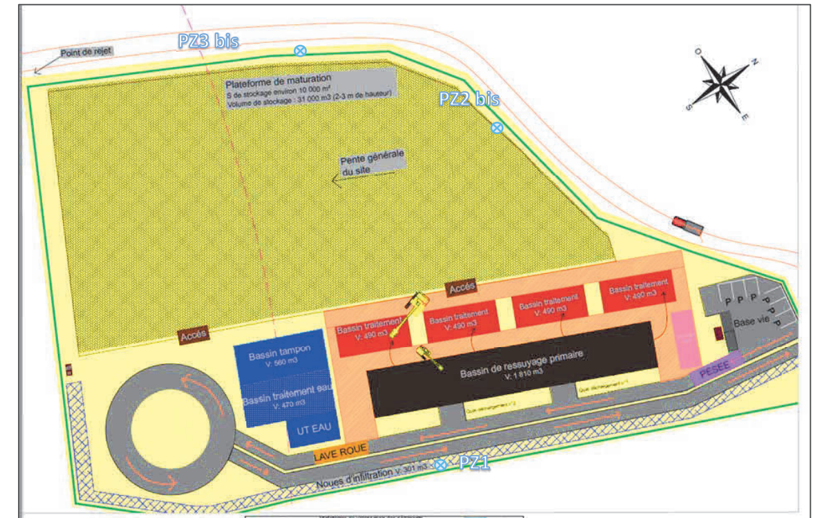
Figure 9 : Emplacement des piézomètres sur la plateforme
