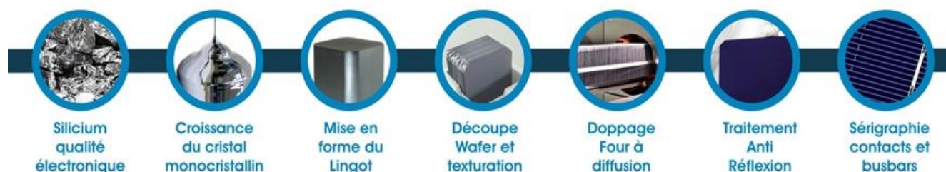
Figure 28 : Procédés de fabrication d'une cellule cristalline semi-conductrice de silicium (Jade Technologie, s.d.)
