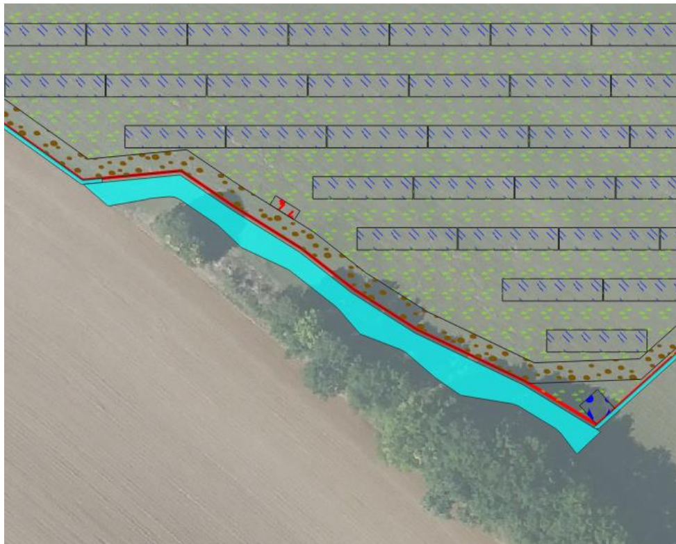
Figure 21 : Implantation de la noue du BV 1
