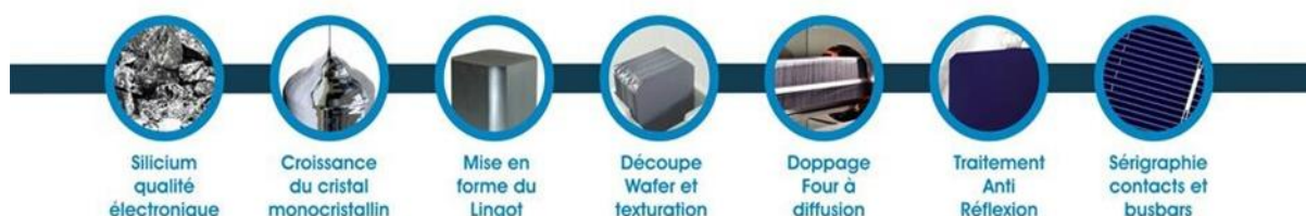
Figure 4 : Procédés de fabrication d'une cellule cristalline semi-conductrice de silicium – Source : Jade technologie
