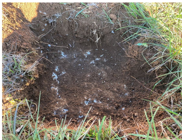
Figure 6 : Vue du fond du sondage TM3 : refus sur dalle calcaire.
