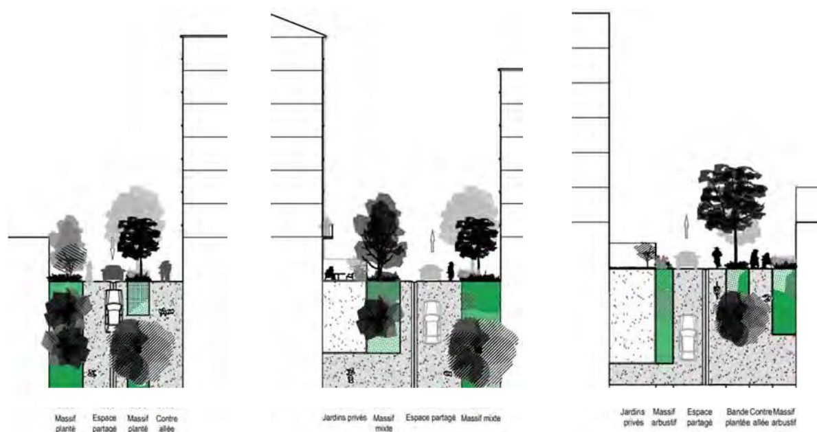
Figure 25: Profil en travers type pour les venelles circulées, phase AVP : Echelle 1/200ème. Sources : Ingerop/Ilex (2022).
