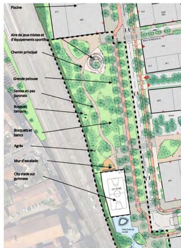
Figure 31: Planche présentation du parc sportif partie Nord, phase AVP : Echelle 1/200 ème . Sources : Ingerop/Ilex (2022).
