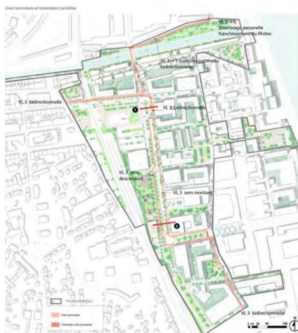
Figure 19: Principes d'implantation des voies lyonnaises 3 et 5 dans le projet, au stade AVP. Sources : Ingerop / Ilex / Présents (2022).
