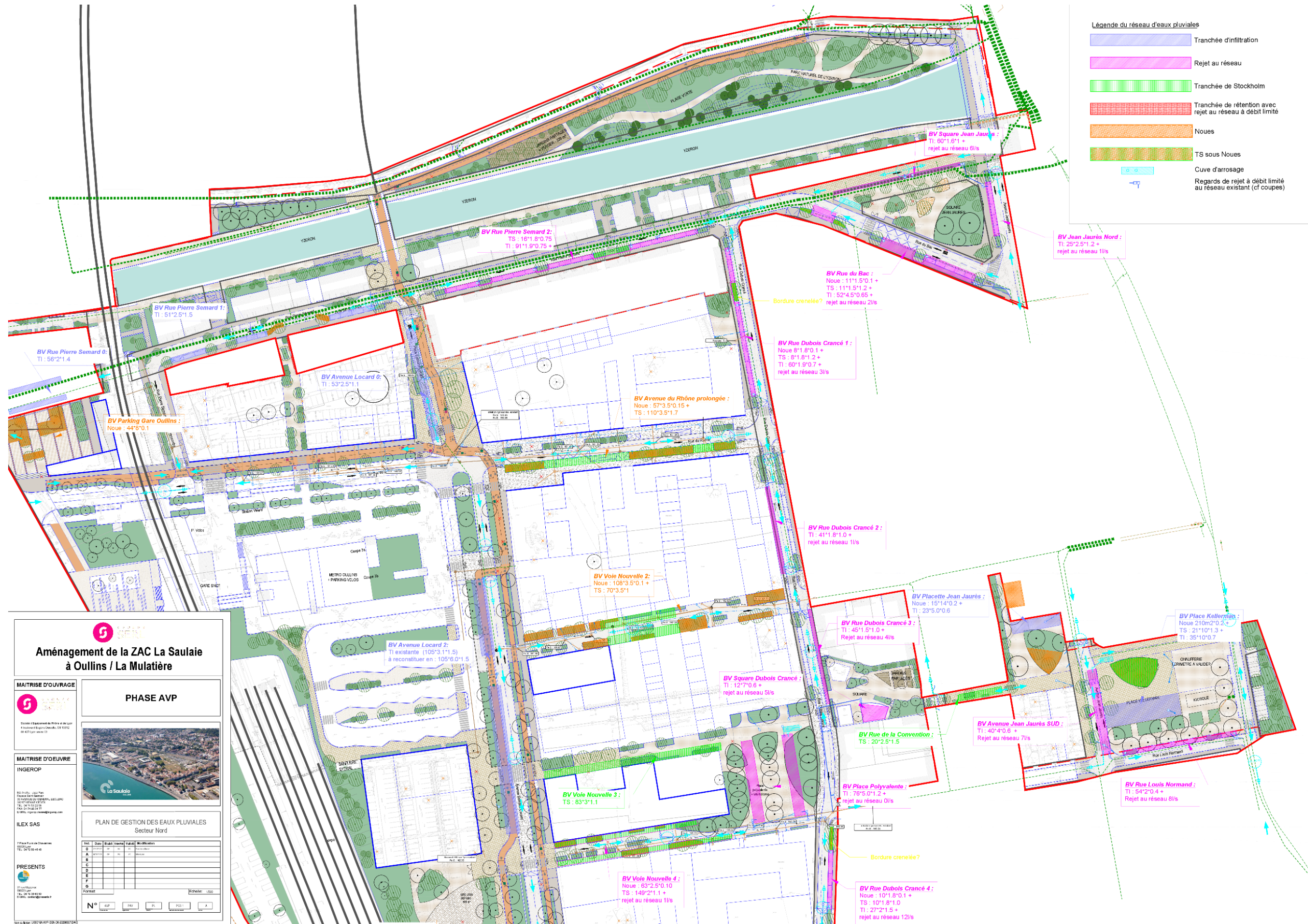
Figure 29 : Plans de l'assainissement projeté
