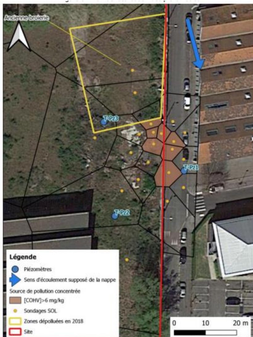
Figure 9 : Localisation des piézomètres (Source : Rapport TESORA Affaire n°A22.2263.A.V1 Suivi eaux souterraines)
