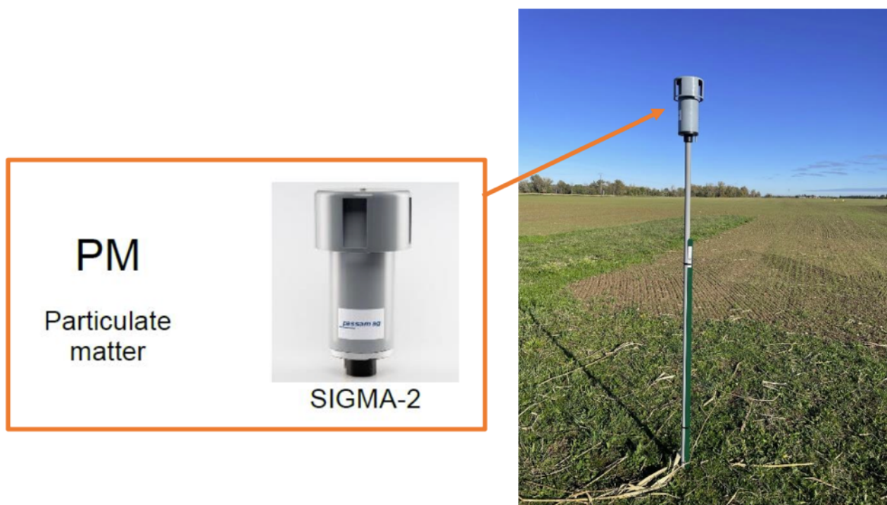
Figure 18 : Dispositifs de mesures passifs utilisé par EVADIES pour le projet CELOSIA
