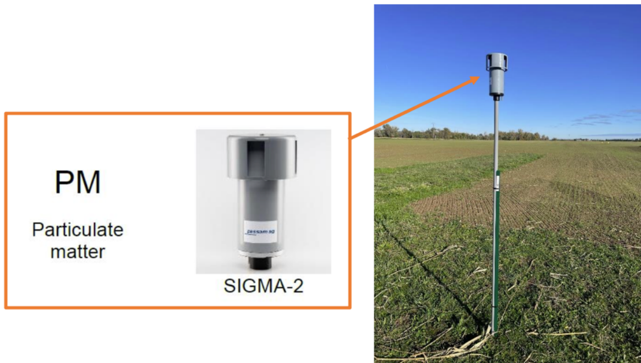
Figure 42 : Dispositifs de mesures passifs utilisé par EVADIES pour le projet CELOSIA
