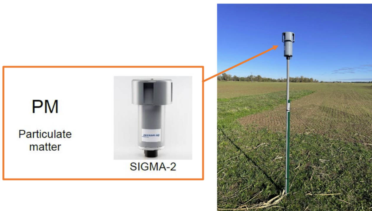
Figure 78 : Dispositifs de mesures passifs utilisé par EVADIES pour le projet CELOSIA
