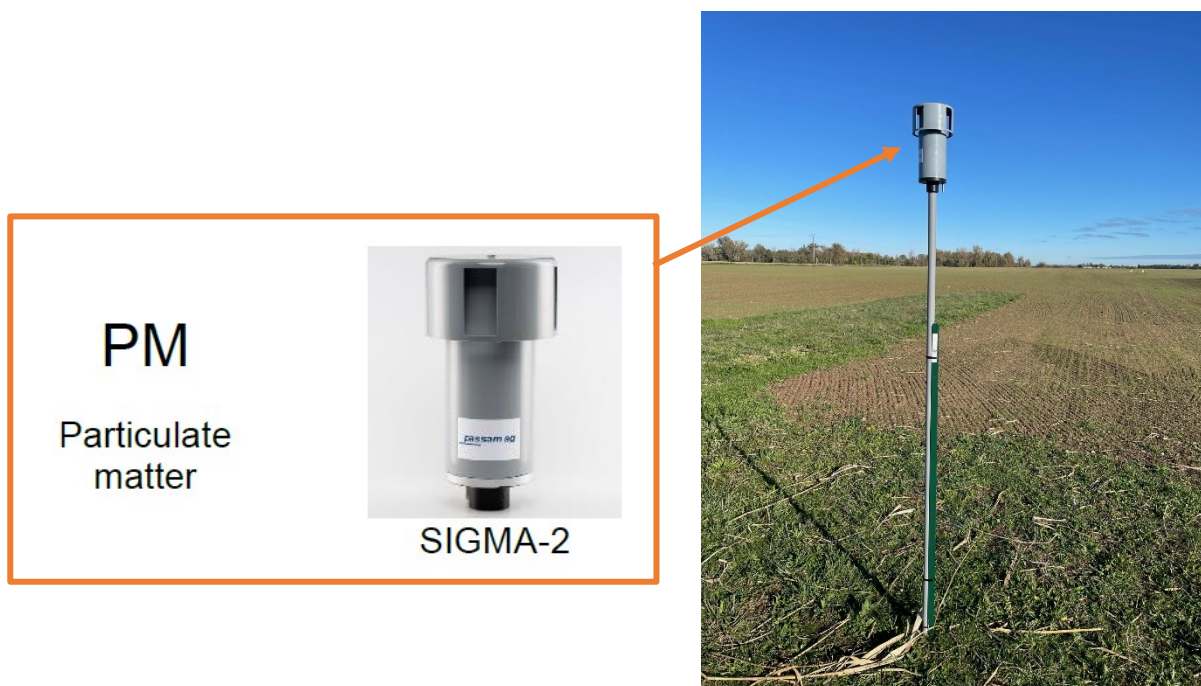
Figure 10. Dispositifs de mesures passifs utilisé par EVADIES
