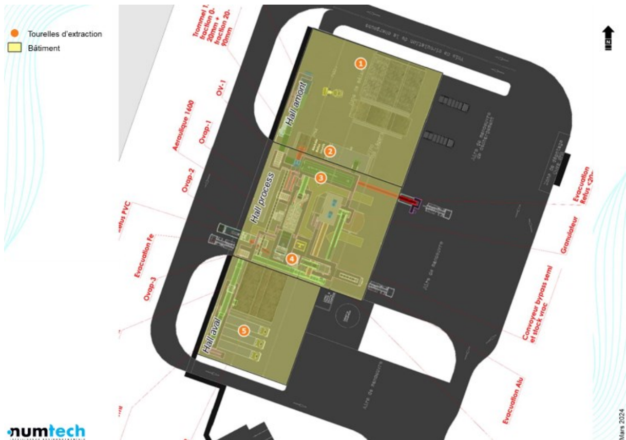
Figure 3. Localisation des tourelles d'extraction
