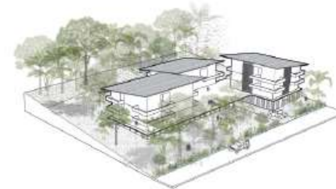
1 | Collectif et intermédiaire Des parkings semi-enterrés offrant une terrasse commune aux habitants
