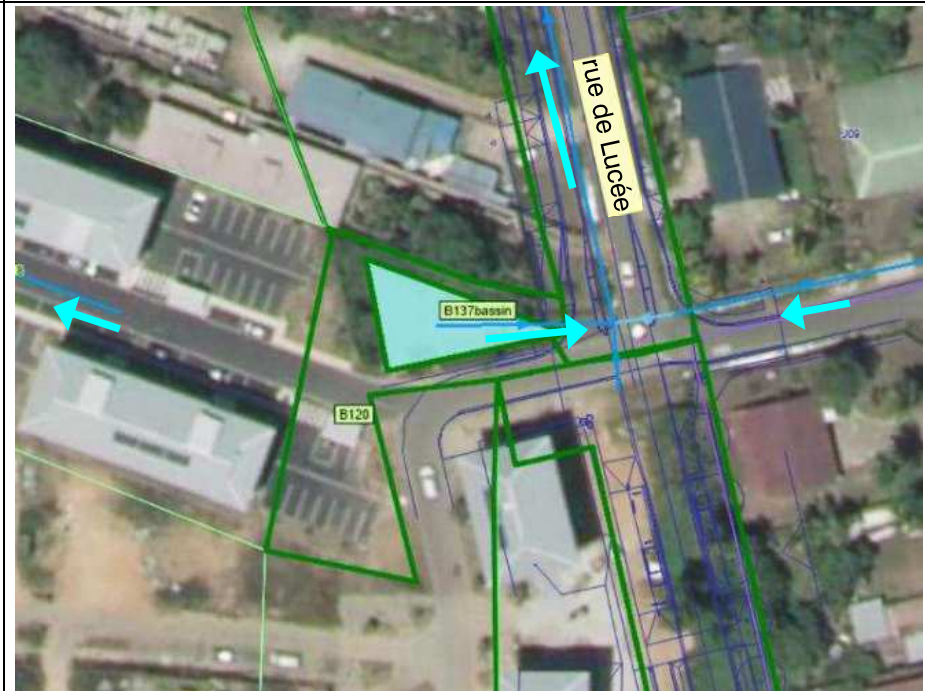
Secteur 1 : localisation du bassin de rétention B137 dont l'exutoire est le réseau pluvial de la rue de Lucée. Il collecte les eaux du BV B120
