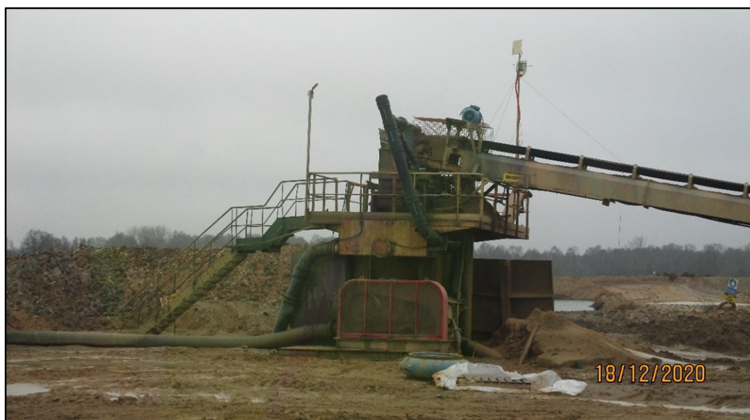
Figure 28. Photographie de la station de mise en pulpe : arrivée du tout-venant par bande transporteuse et départ en canalisation
