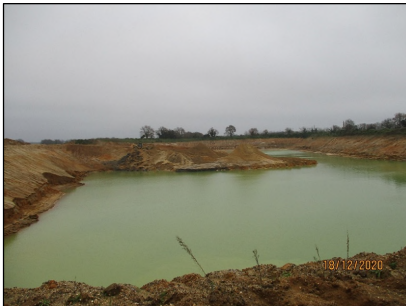
Figure 26. Photographie d'un stockage des matériaux extraits en cordon pour égouttage au niveau de la zone d'extraction
