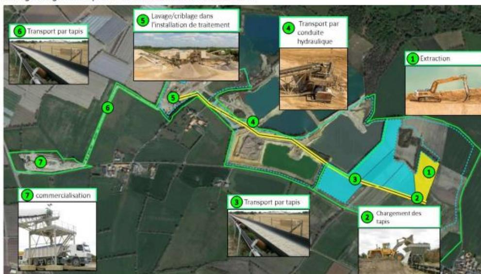
Figure 10 - Moyens et méthodes d'exploitations (source : Dossier d'autorisation - GSM Granulats)
