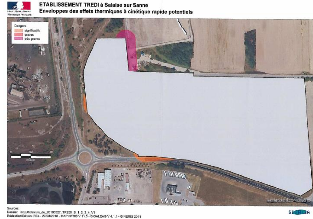
Figure 41 : Carte d'intensité des effets thermiques au sol (enveloppes des effets thermiques à cinétique rapide potentiels) - TREDI
